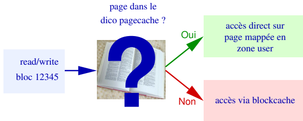
FIG. 5 – Scénario de prise en charge des lectures/écritures par blockdev en passant par pagecache et éventuellement blockcache .
